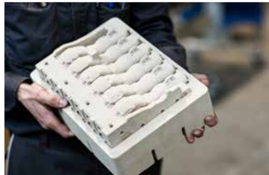
Operatorzy Johan Arvidsson (z lewej) i Lars Widhensparr pracują przy usuwaniu piasku z gotowych rdzeni. Produkcja piaskowych rdzeni 3D jest szybsza niż praca tradycyjnymi metodami, ponieważ wymaga mniejszej liczby kroków.
