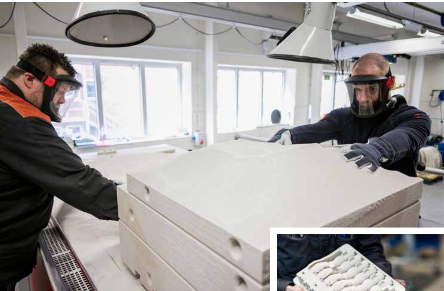
Operatorzy Johan Arvidsson (z lewej) i Lars Widhensparr pracują przy usuwaniu piasku z gotowych rdzeni. Produkcja piaskowych rdzeni 3D jest szybsza niż praca tradycyjnymi metodami, ponieważ wymaga mniejszej liczby kroków.
