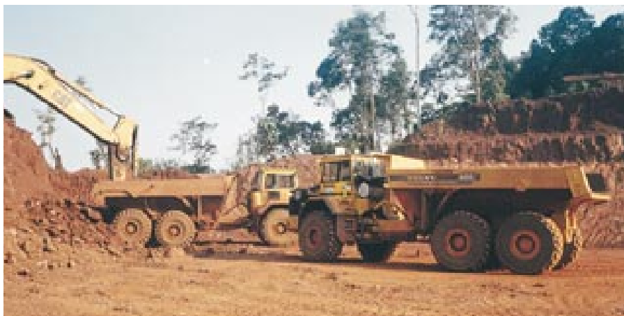
Os caminhões Volvo A35C movimentam terra suficiente para encher um estádio tamanho do Pacaembu por mês
