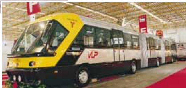
Fura-Fila com chassi Volvo e motores elétricos: modernidade em São Paulo
